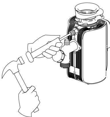
Удаление диафрагмы для подключения посудомоечной машины
