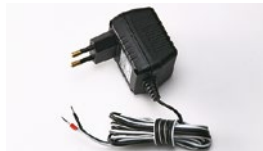
Фото 18. Внешний блок питания электропривода от сети ~220 В
