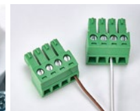
Фото 14. Подключение провода датчика к ответной части разъема
