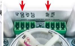
Фото 13. Клеммы подключения проводных датчиков — INP, GND
