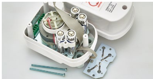
Фото 17. Контактная площадка снята, батарейки могут быть заменены
