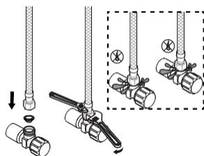
Подключите гибкую подводку к системе водоснабжения с помощью двух регулируемых. Ключей (избегайте скручивания или перекручивания подводки). Включите воду и проверьте соединения на герметичность.
