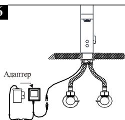
1. Просверлите отверстие диаметром 6 мм в соответствующем месте на стене, а затем прикрутите батарейный отсек к стене.
