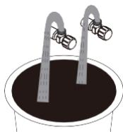
Перекройте воду в системе водоснабжения. Очистите крепежные элементы и поверхности. Замечание: при первичной установке включите воду и дайте воде свободно течь в течение 60 секунд. Затем отключите воду.
