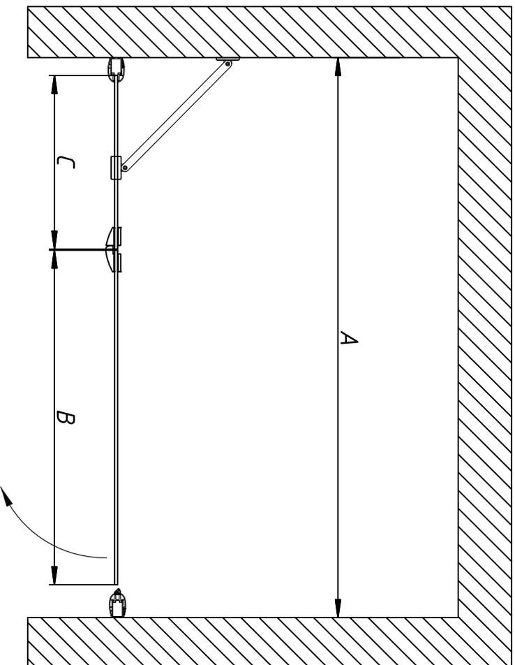
Регулировка осуществляется путем выдвижения профиля. Размеры указаны в мм.
