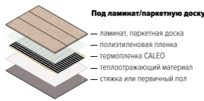
Рис. Схема монтажа теплого пола CALEO под ламинат или паркетную доску
