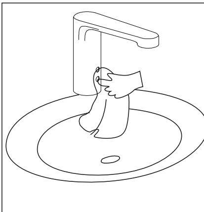
После окончания монтажа смесителя, мягкой тканью протрите датчики сенсора.
