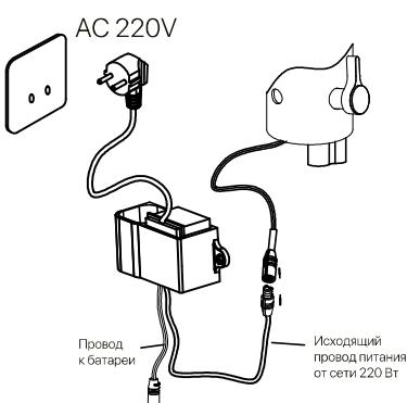
Если вы планируете использовать в качестве источника питания переменный ток 220 Вт, тогда исходящий штекер адаптера соединяется со входящим штекером смесителя.
