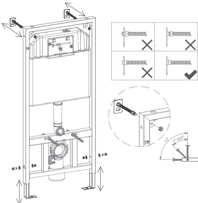
3. Поместите инсталляцию на стену, к которой Вы ее смонтируете. Отметьте стену по корректным точкам крепления к стене и полу. Просверлите отмеченные точки на стене сверлом  $\varnothing 10$  мм. Требуется по крайней мере 70 мм глубиной. Примечание: Проверьте уровнем прямоту установки скрытой системы перед затягиванием гаек.
