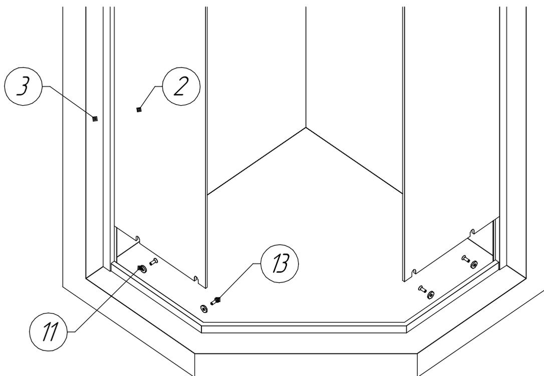
5. Вставьте верхнюю трапецию(4) в пазы пристенных профилей. Закрепите стекло к трапеции при помощи шайб(11) и винтов(13).
