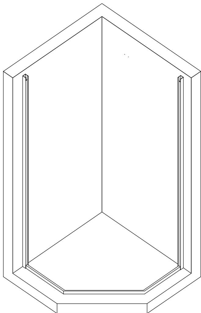
4. Вставьте боковое(2) стекло в паз пристенного профиля(3) и при помощи шайб(11) и винтов(13) закрепите стекло к трапеции(4). Проведите аналогичные действия со вторым боковым стеклом.
