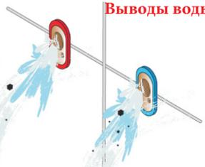
**Примечание: Перед установкой прочистите выходы от загрязнений. Вывод для горячей воды устанавливается слева, а холодной - справа.**
