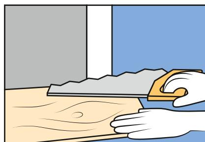
11. Подгоните доску, чтобы она встала на место, вклейте на место отпиленный кусок, установите распорку между стеной и доской и закройте зазор вокруг трубы специальным кольцом.
