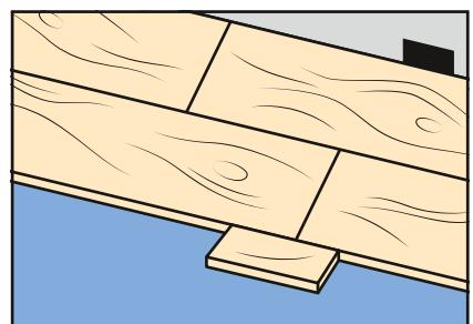
6. Для быстроты и продуктивности укладки следующий ряд рекомендуется укладывать рядом с предыдущим. Соедините торцы всех досок ряда и зафиксируйте торцевые соединения с помощью обрезков доски. Затем поднесите весь ряд к предыдущему ряду и состыкуйте их друг с другом. Необходимо контролировать, чтобы все расстояния между торцами досок соседних рядов было не менее 50 см, это придаст паркету необходимую прочность.
