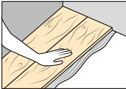
7. Расположите торец следующей доски под углом и соедините торцы. После этого надавите на длинный край доски так, чтобы гребень вошел в паз. Не прижимайте доску к kleю. Продолжайте укладку тем же способом до конца ряда.
