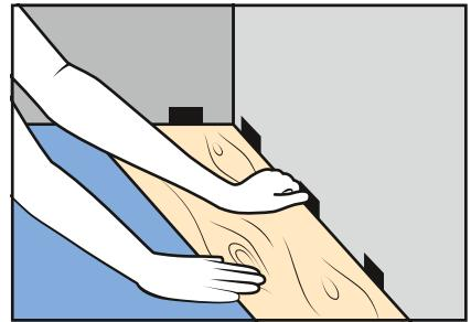
2. Первый ряд. Помните, что доски предпочтительно укладывать по длине комнаты. Начинайте укладку с угла, расположенного по левую руку, двигаясь вправо. Уложите первую доску стороной с пазом к стене. Расположите торец следующей доски под углом, затем, надавив, соедините торцы. Между напольным покрытием и стеной установите распорки для создания компенсационного зазора 8-10 мм.
