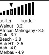
Hardness scale | Шкала твердости | Твердість деревини | Skala tvrdoće drveta | Scala de duritate a lemnului | Скала на твердост на дрвото | Скала за твърдост на дървото | Skala tvrdoće drveta | Lestvica trdote lesa | Shkalla e ngurtësise së drurit
