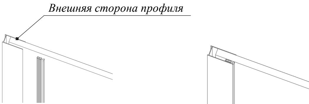
*3. Пройдите силиконовым герметиком низ стекла, а также внутреннюю и внешнюю части пристенного профиля. При помощи очистителя для стекол, удалите излишки силиконового герметика, пока он не застыл. Не рекомендуется использование перегородки в течении 24 часов, после нанесения герметика.*
