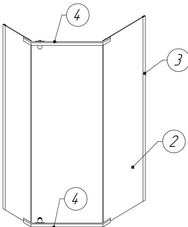
6. Разберите петли на трапециях (4) и установите стекло двери (1). Установите на стекло ручку (5). Установите магнитный уплотнитель (6) на дверцу (1) и стационарное стекло (2). Установите уплотнитель (9) на стационарное стекло. Установите уплотнитель (7) на дверцу. На низ двери установите уплотнитель (8).
