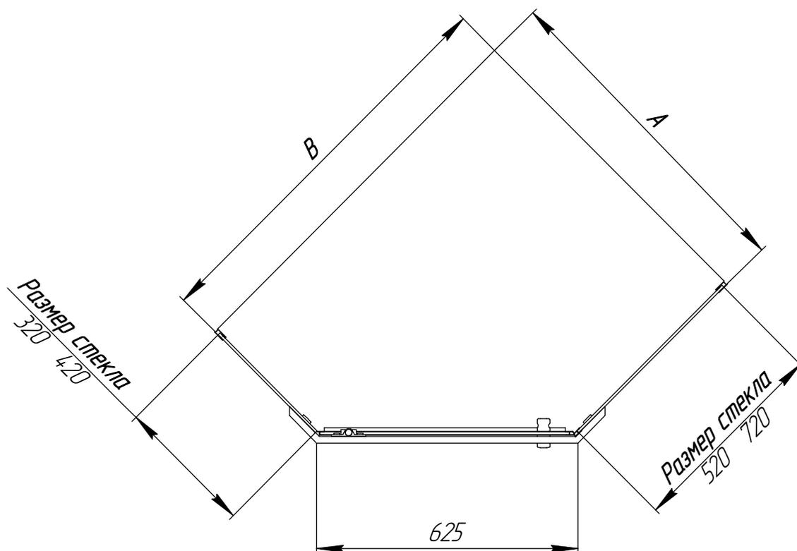
**Регулировочный размер А - от угла до наружной кромки профиля изделия.**
