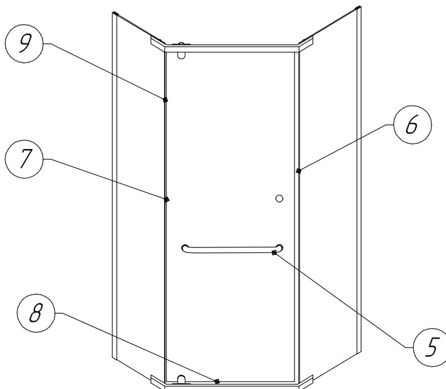
7. Затяните винты крепления стекла к трапеции (4) сверху и снизу. Ослабьте винты регулировок на верхней и нижней трапеции (4). Отрегулируйте стекло дверцы (1) и затяните винты. Так же отрегулируйте трапецию по отношению к стационарным стеклам при помощи винтов регулировки стекла.
