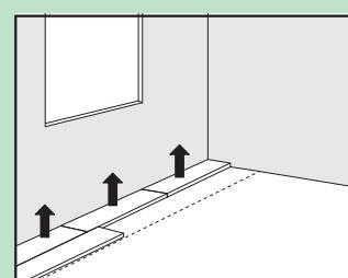
Нанесите на пол слой винилового клея примерно по ширине двух первых рядов. Стого следуйте инструкциям на упаковке винилового клея. Рекомендуется использовать специально разработанный фирменный виниловый клей.
