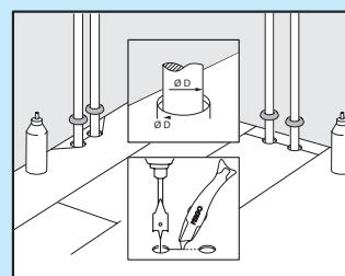
Если отверстия располагаются с длинной стороны панели, выполните разрез под углом 45 градусов от каждого отверстия к краю панели. Затем приклейте ее на место. Заполните стыки вокруг трубы.
