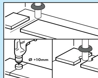
Если две трубы расположены рядом, просверлите в каждой намеченной точке отверстие диаметром, равным диаметру труб.
