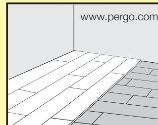
Для укладки панелей пола необходимо использовать фанеру толщиной не менее 6 мм. Уберите все препятствия. Соединение гвоздями выполняйте с помощью круглых ребристых гвоздей в формате решетки с расстоянием между гвоздями 75 мм по периметру и 150 мм в центре.
