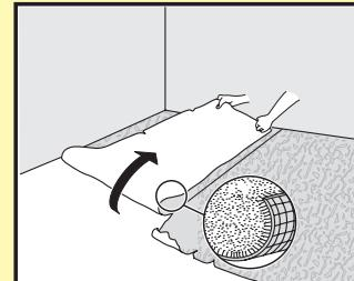
При выполнении монтажа поверх деревянного чернового пола содержание влаги в древесине не должно превышать 10%. Кроме того, поверхность под деревянным черновым полом должна быть абсолютно сухой. При наличии подполья под дощатым полом необходимо обеспечить его вентиляцию. Уберите все препятствия и убедитесь в наличии достаточной вентиляции (минимум 4 см<sup>2</sup> общей площади вентиляционных отверстий на м<sup>2</sup> пола).
