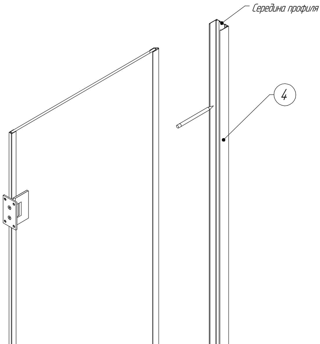
8. Нанесите силикон на пазы профиля (4) а так же на профиль (3), для закрепления магнитной ленты в нем.
