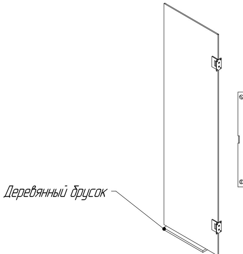
3. Удерживая дверь на месте, отметьте отверстия для обеих петель (6). Просверлите сверлом, вставьте пластиковый дюбель (8) и закрепите при помощи винтов (9) к стене.
