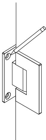
4. Прикрепите магнитный профиль (2) на стекло (1) промазав герметиком. Так же нанести герметик между профилем (2) и магнитной лентой.
