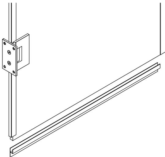
7. Приложите пристенный профиль (4) к противоположной стене, где установлены петли. Выставьте профиль при помощи уровня так, чтобы ранее установленное стекло смотрело в паз профиля по середине. Отметьте через отверстия в профиле, просверлите, вставьте пластиковый дюбель (8) и закрепите профиль винтами (9).
