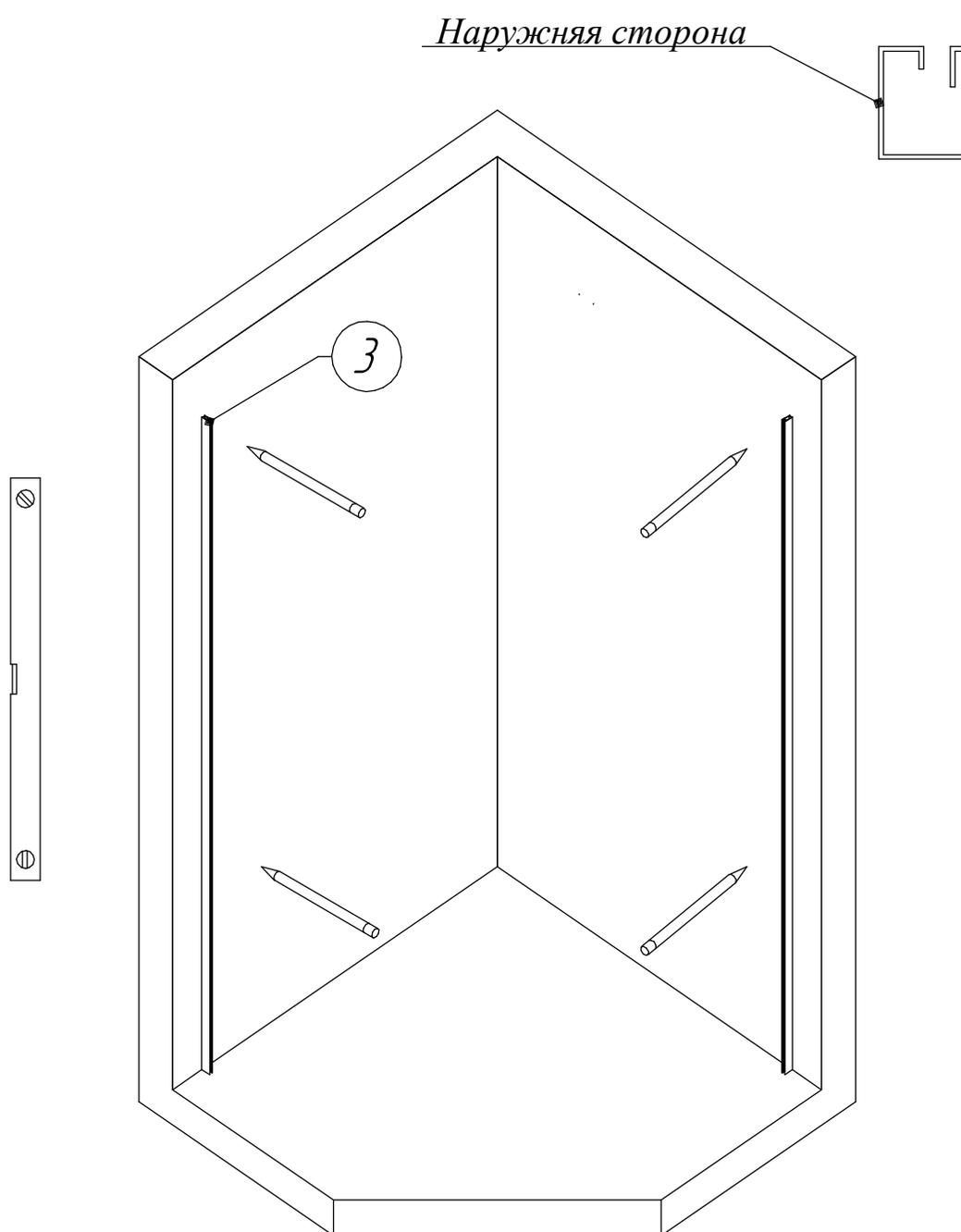
4. Нанесите в паз профиля (3) слой герметика. Вставьте боковое (2) стекло в паз пристенного профиля (3), зафиксируйте стекло к профилю (3). Проведите аналогичные действия со вторым боковым стеклом.
