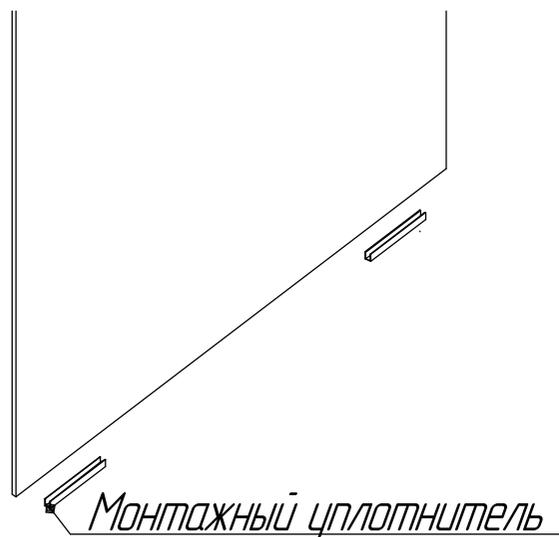
6. Разберите петли на трапециях (4) и установите стекло двери (1). Установите на стекло ручку (5). Установите магнитный уплотнитель (6) на дверцу (1) и стационарное стекла (2). Установите уплотнитель (9) на стационарное стекло. Установите уплотнитель (7) на дверцу. На низ двери установите уплотнитель (8).
