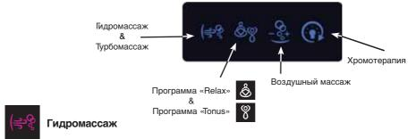
Одно нажатие на эту клавишу (пиктограмма становится фиолетовой) запускает подачу воды через форсунки, расположенные на стенках ванны:
