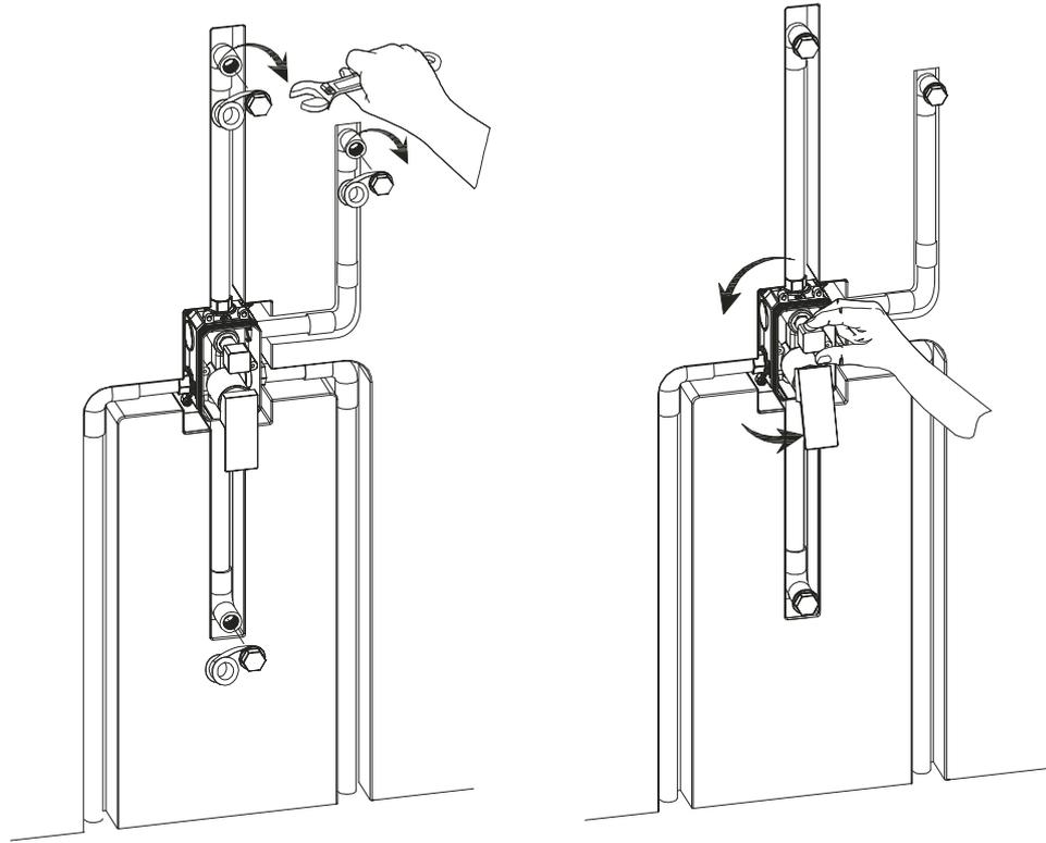
Выполнить проверку герметичности соединений под давлением до 1,6 МПа, не менее 10 минут на каждом режиме работы
